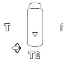
Bušenje na betonu/cigli
